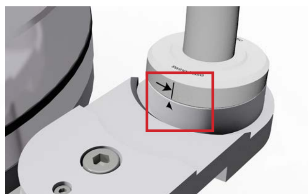
Abb. 15b: Montage der swing base (nach hinten)
