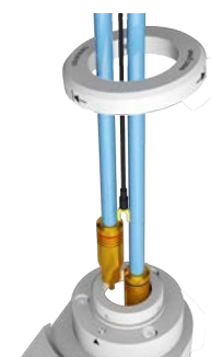
Abb. 13 Einsetzen des TT5 Tonarmes
